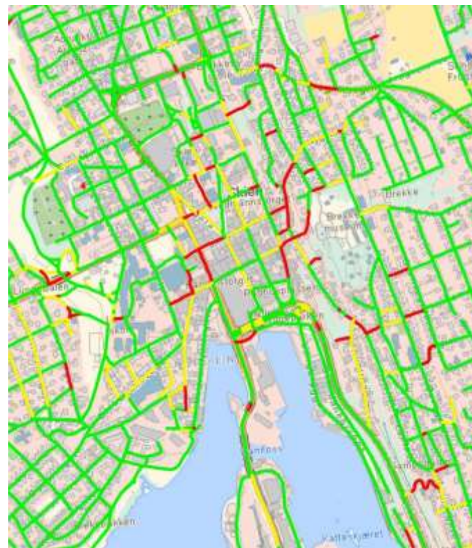
Figur 14 Helningskart Skien sentrum. Asplan Viak Grønn under 1:20 (0- 5%) Gul mellom 1:20 og 1:12 (5.1 – 8.3 %) Rød over 1:12 (8.4 - 64.1%)
