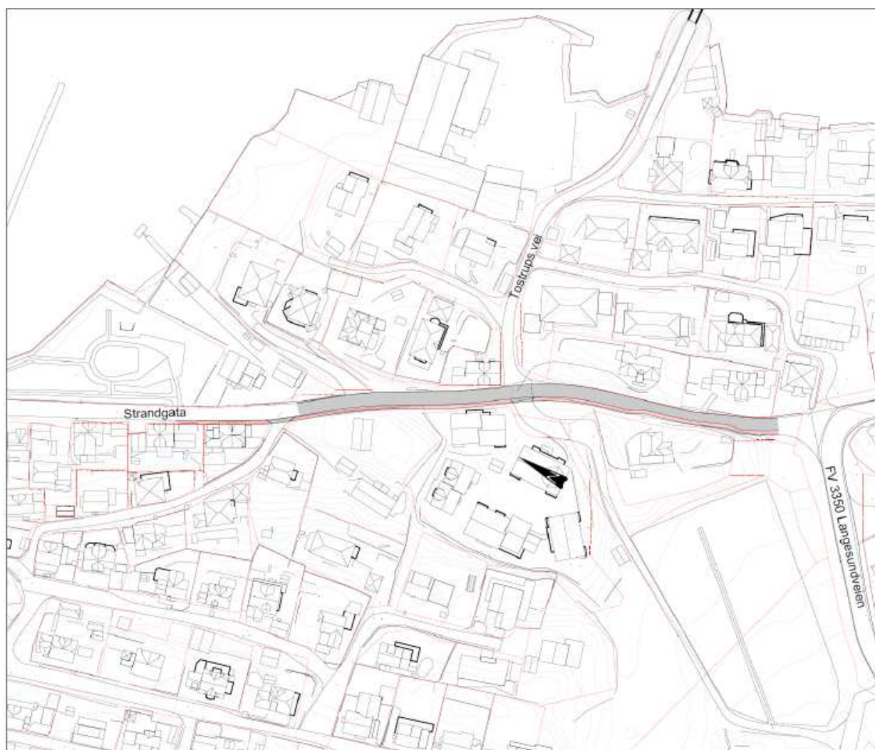
Skisse som viser forslag til fortaulsøsning med innsnevring til ett kjørefelt på en kortere strekning
