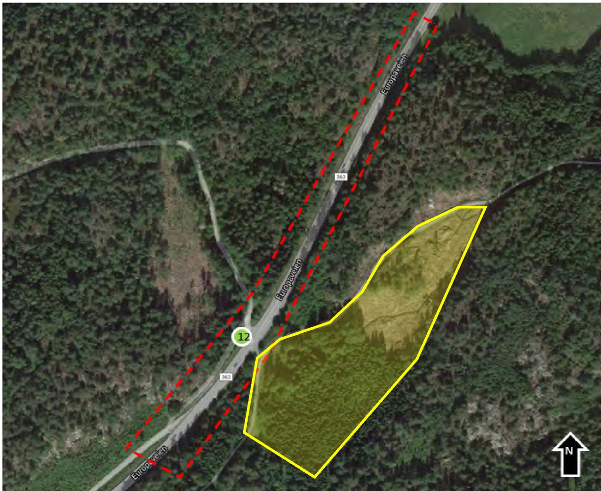
Figur 9: Flyfoto med omtrentlig utstrekning av profil 1450-1900 (rødt) med omtrentlig plassering av totalsondering 12. www.google.maps.no Området er aktuelt for lagring av sprengstein.
