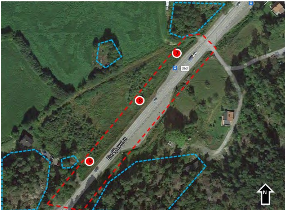
Figur 6: Skråfoto over profil 700-900 med omtrentlig plassering av totalsondering 7-9. Rødt og oransje indikerer forekomst av sprøbruddmateriale/kvikkleire. Grønt indikerer ikke sensitive masser. Blå polygon viser områder med fjell i dagen.
