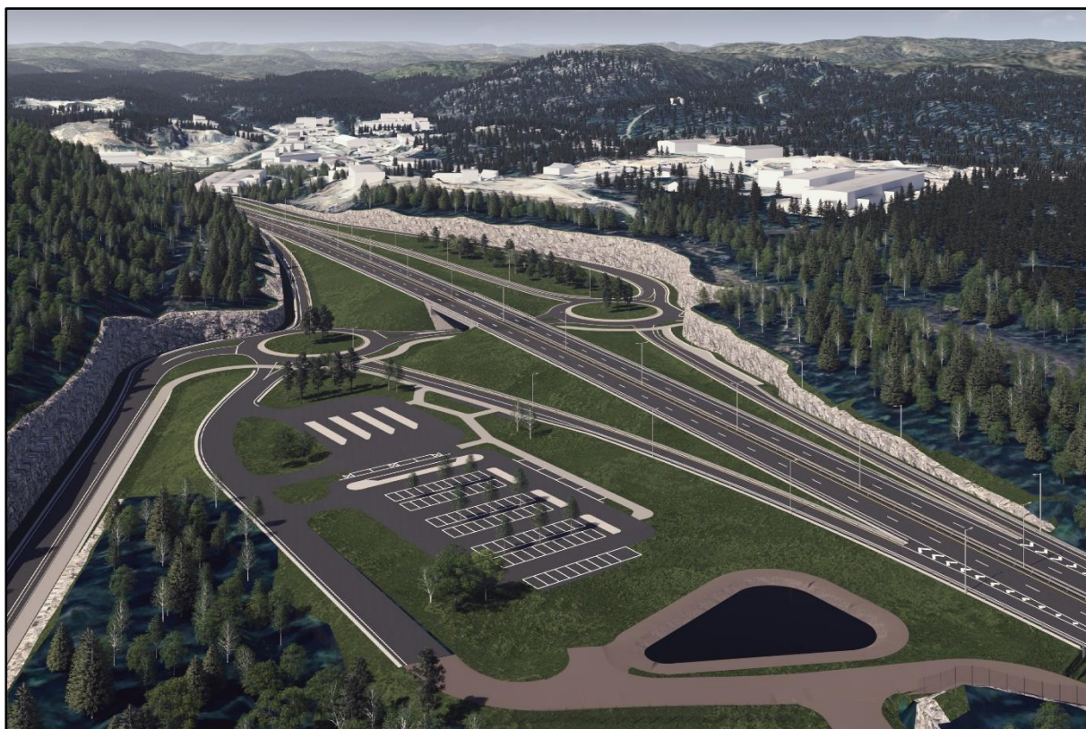
Figur 3-9: Løsning for kollektivanlegg og pendlerparkering ved Fikkjebakkekrysset, sett fra øst. (Kilde: Sweco)
