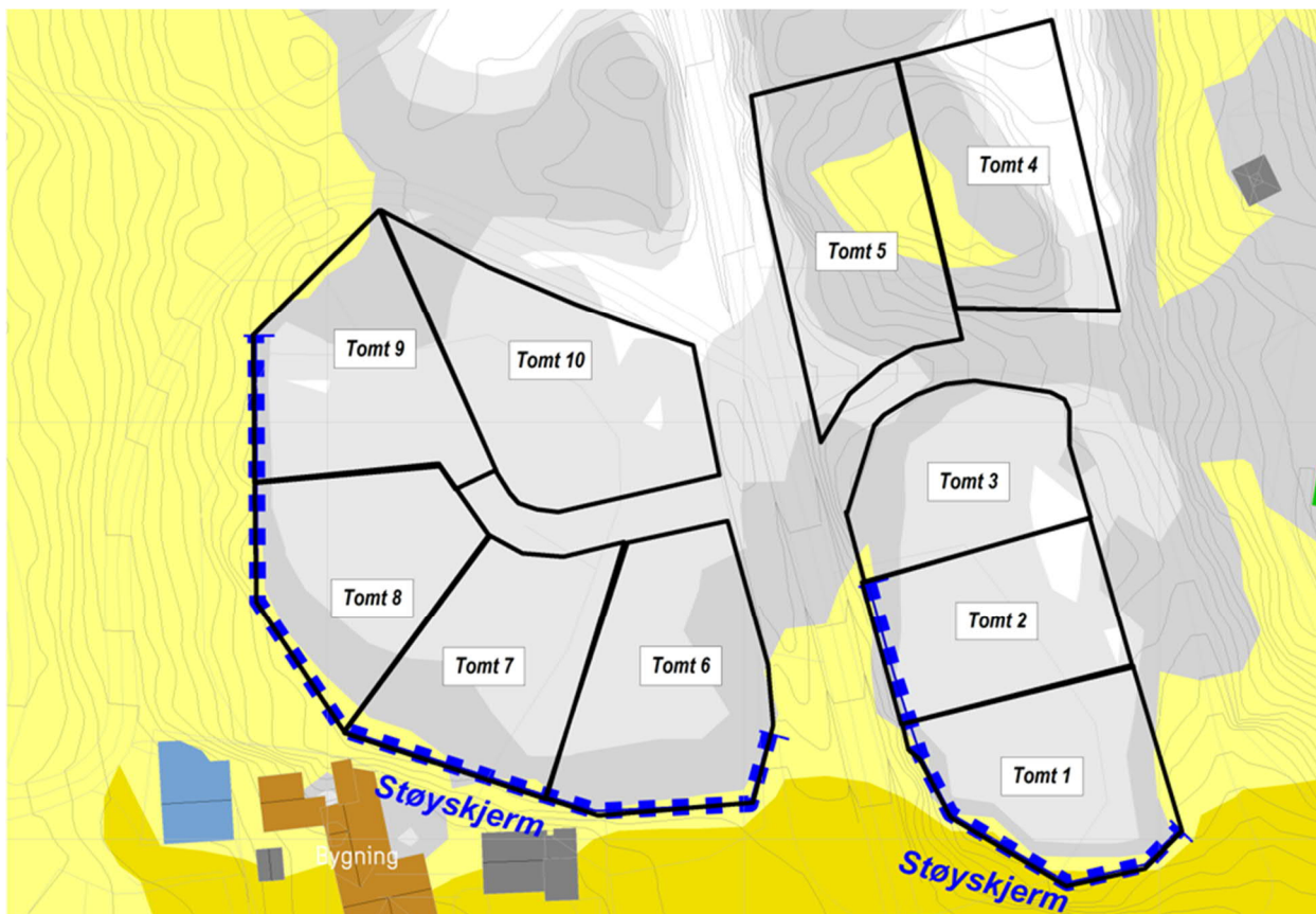
Figur 7: Mulig situasjon som i figur 6 med planert terreng (kotehøyde +19 m for B1 og +24 m for B2) og støyskjerming langs tomtgrense. Skjermers vist i blått. Skjermhøyde 1,5 meter over terreng.
