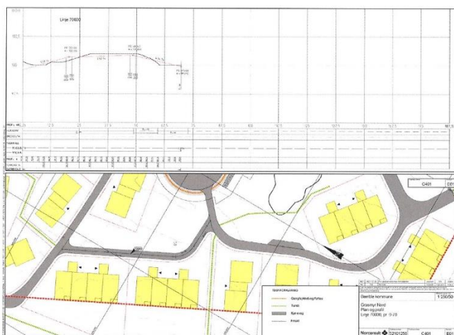
Figur 32: Plan og profil C401_E01. Gang- og sykkelveg (SGS4) med kjøreadkomst inn til boligfelt BKS6.
