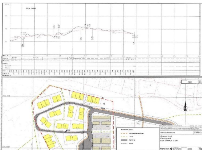
Figur 31: Plan og profil C201_E01. Gang- og sykkelveg (SGS4) med kjøreadkomst inn til boligfelt BKS1-5.
