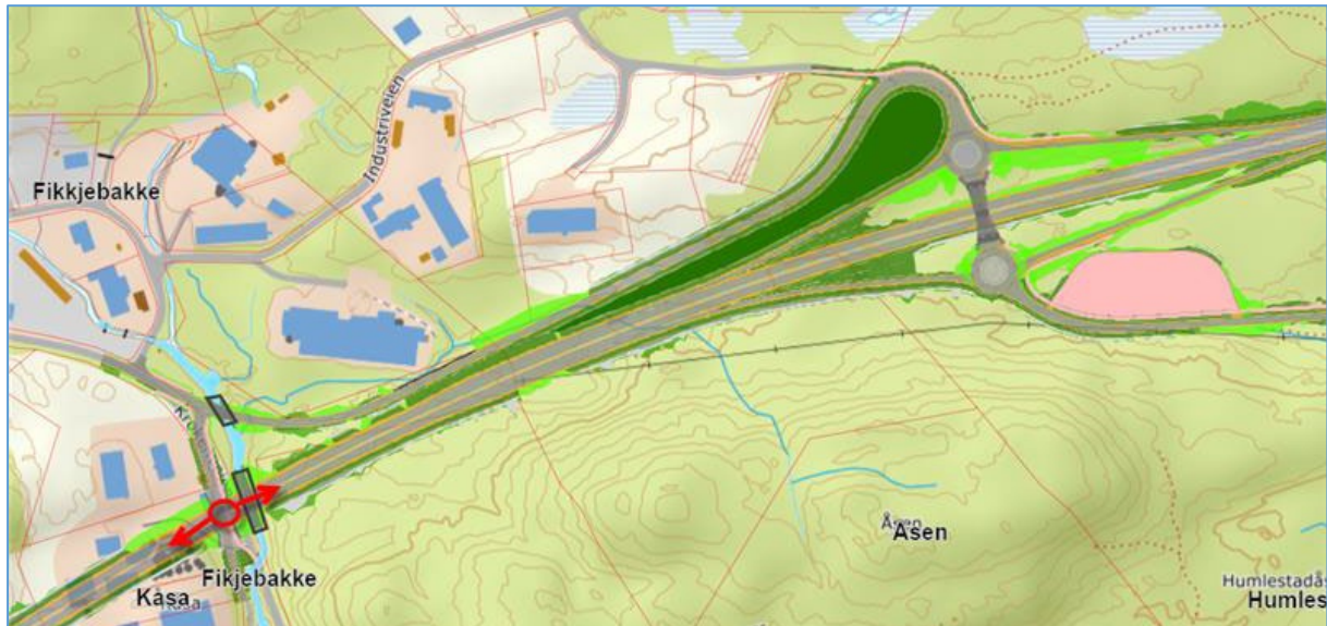
Figur 4-7 Alternativ midlertidig rundkjøring for å ivareta kryssing av eksisterende trafikk og anleggstrafikk, og etablere avkjøring inn i prosjektområdet ved Fikkjebakke er vist i rødt.
