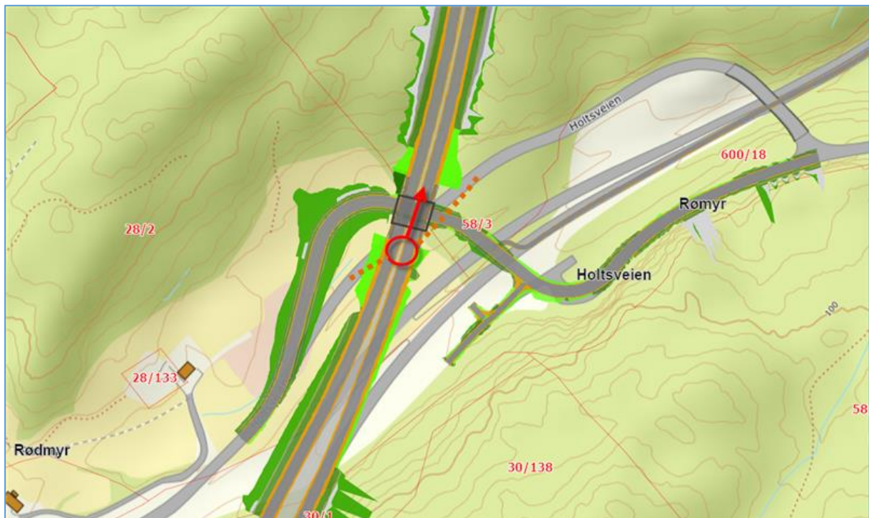
Figur 4-27 Tvedestrand: Alternativ midlertidig rundkjøring for å etablere avkjøring til anleggsområdet fra Holtsveien er vist i rødt.
