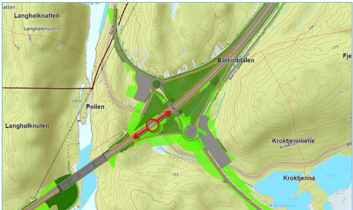
Figur 4-26 Alternativ midlertidig rundkjøring for å etablere avkjøring til anleggsområdet fra fv. 416 Aklandsveien er vist i rødt.
