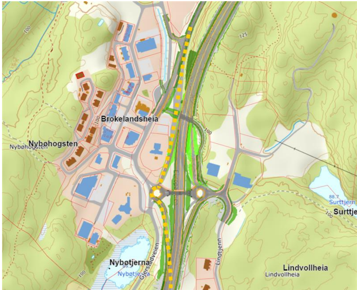
Figur 4-11 Omlegging av trafikk på eksisterende ramper for frigjøring av brukryssing for nybygging (gulorange stiplet linje).
