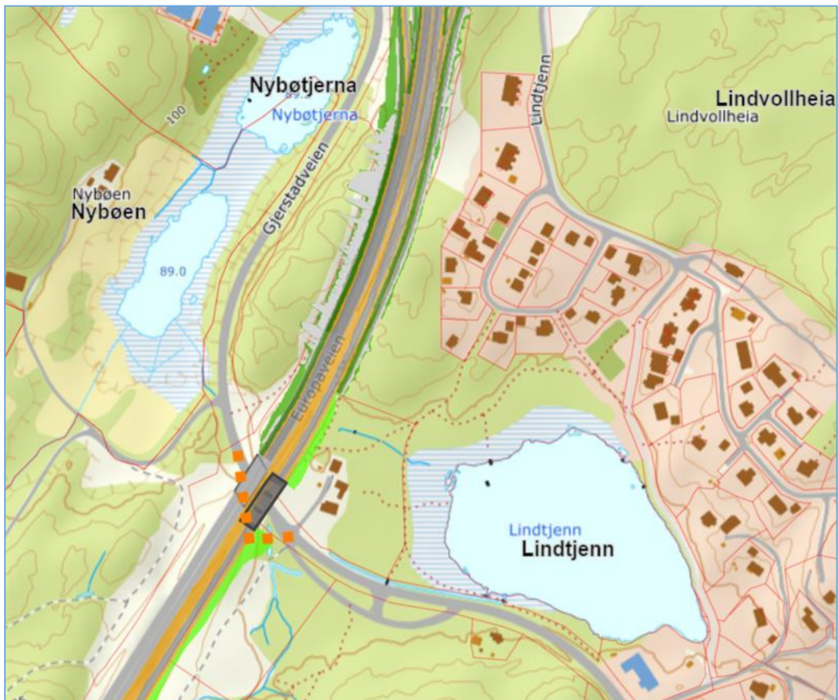
Figur 4-12 Brokelandsheia sør: Ved bygging av ny konstruksjon for E18 (svart boks), vil det bli behov for omlegging av trafikken på fv. 416 (oransjestiplet linje).
