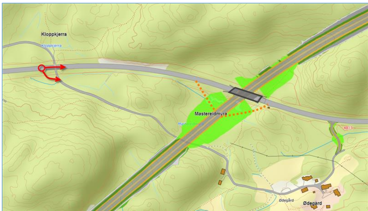
Figur 4-4 Omlegging av trafikk (oransje stippet linje) ved bygging av konstruksjon (sort firkant). Omkjøringen legges på planlagt fylling for bru. Forslag til alternativ midlertidig rundkjøring med avkjøring inn i prosjektområdet er vist i rødt.
