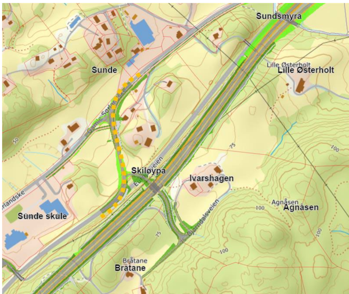
Figur 4-10 Abel skole: mulig omlegging av trafikk mellom eksisterende E18 og fv. 3688 ved bygging av ny E18 i eksisterende korridor (gulorange stiplet linje).
