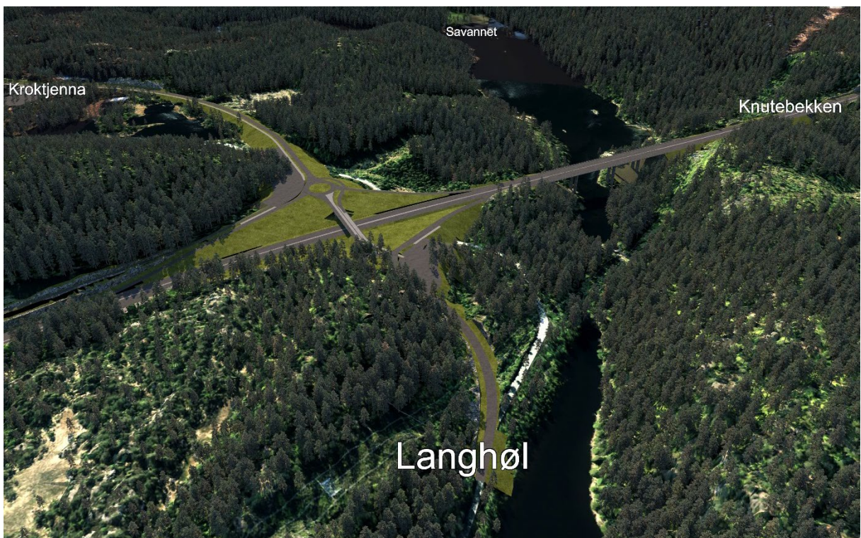
Figur 6-6: Utsnitt av 3D-modell av Risørkrysset, sett mot sørøst. Krysset er et "ruterkryss" hvor fv. 416 krysser over ny E18. Mot Kroktjenna fortsetter ny tilførselsvei ned mot Vinterkjær. Det er planlagt kollektivterminal sør for krysset, i tilknytning til rundkjøring.
