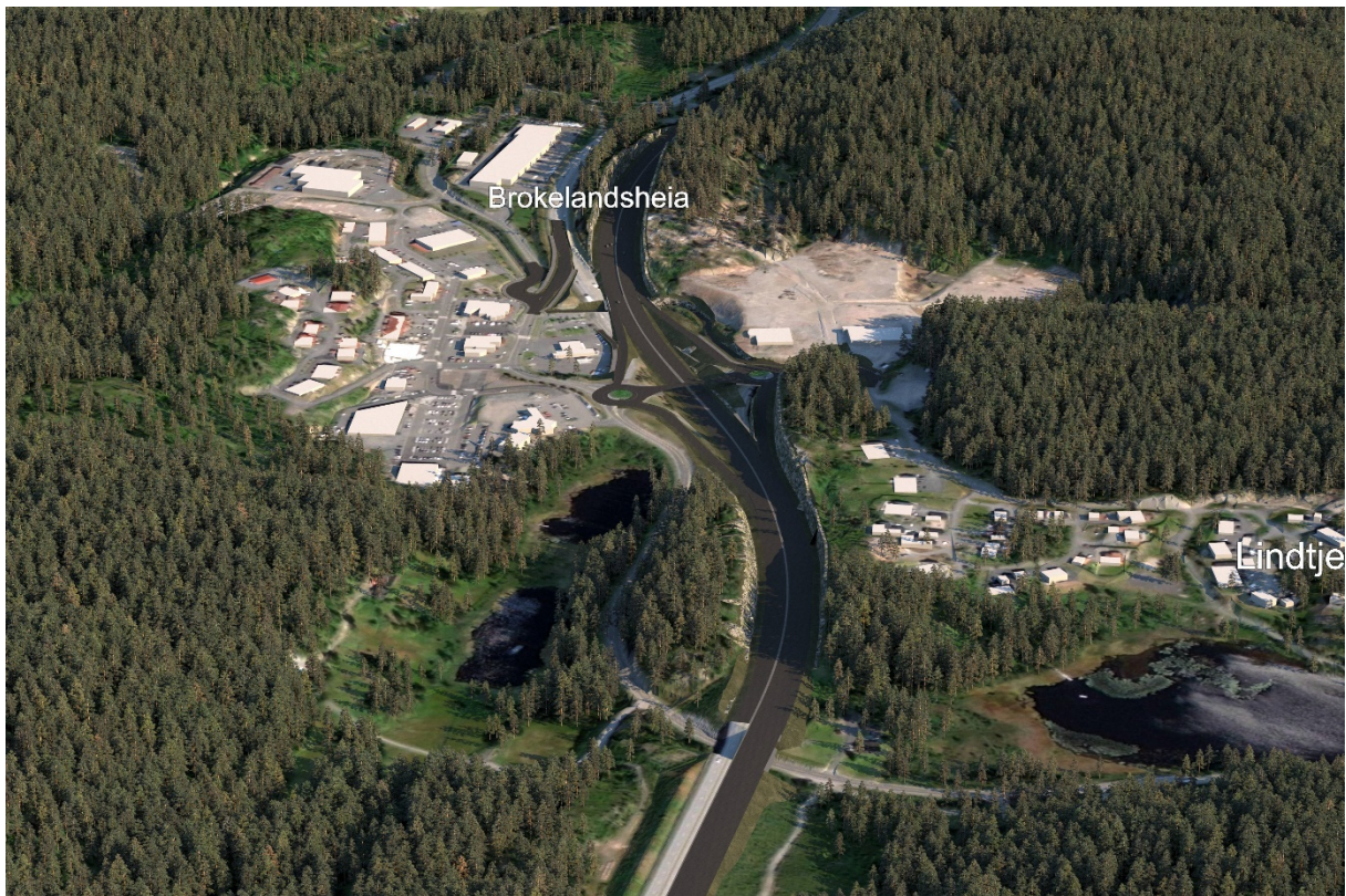
Figur 6-5: Utsnitt av 3D-modell av Brokelandsheia kryssområde, sett mot nordvest. Krysset er utformet som er "ruterkryss", med lokalvei kryssende over ny E18, og utforming og plasseringen er tilnærmet som for dagens kryss.
