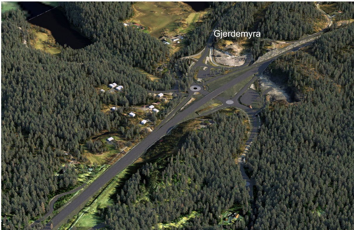
Figur 6-3: Utsnitt av 3D-modell av Gjerdemyra kryssområde, sett mot nord. Krysset er utformet som et "ruterkryss", med Drangedalsveien kryssende under ny E18. Dagens E18 beholder sin trasé, og kobles til Drangedalsveien vest for nytt kryss. Kollektivholdeplasser er tenkt under overgangsbrua, med pendlerparkering nordøst i kryssområdet.
