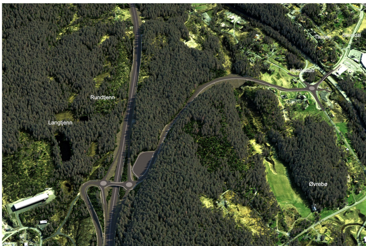
Figur 6-2: Tilførselsvei fra Tangen til Fikkjebakke med separat gang- og sykkelvei, (sett mot øst).
