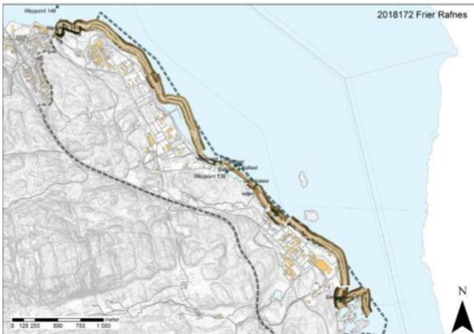
Figur 6-10 Kart som viser omfanget av kartlegging av sjøbunn med sidesøkende sonar. Kart NNM/Morten Reitan
