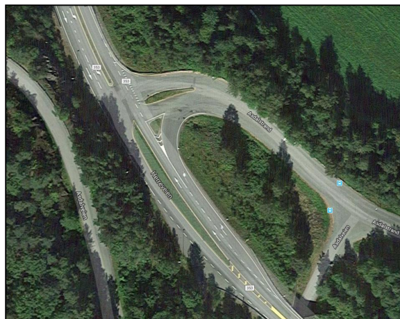
Figur 6-37 Avkjøring til Rønningen industriområde. Kanalisert kryss mellom fv. 353 og avkjøring til Rønningen industriområde. 65 meter langt venstresvingefelt fra nord. Høyresvingende avkjøringsrampe fra sør. Gang-/sykkelveg fra krysset Asdalsveien x Asdalstrand og innover mot industriområdet på Rønningen. (google.com/maps, 21.02.2019).
