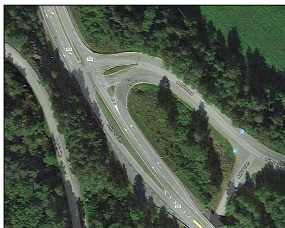
Figur 3-17 Avkjøring til Rønningen industriområde. Kanalisert kryss mellom fv. 353 og avkjøring til Rønningen industriområde. 65 meter langt venstresvingefelt fra nord. Høyresvingende avkjøringsrampe fra sør. Gang-/sykkelveg fra krysset Asdalsveien x Asdalstrand og innover mot industriområdet på Rønningen. (google.com/maps, 21.02.2019).
