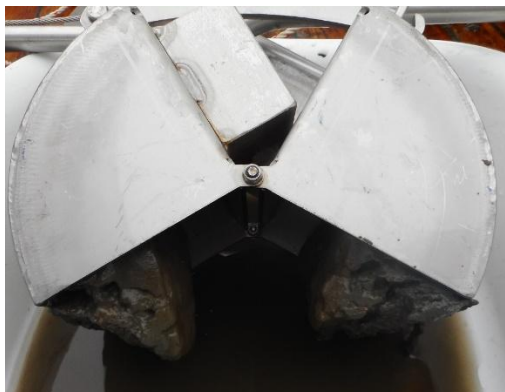
Figur 6: Bilde av Van Veen grabb benyttet ved sedimentundersøkelsene. Det er her akkurat tatt opp en prøve ned til ca. 5 cm, der massene har beholdt sine opprinnelige strukturer.
