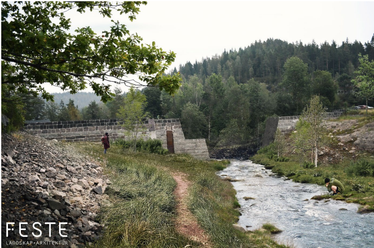
Figur 25: fotomontasje som viser hvordan vannstrengen fra Iona og ned mot gyteelva kan utformes
