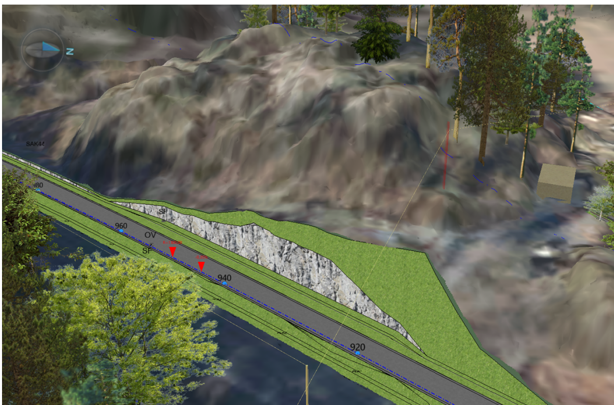
Figur 53: 3D-modell av ferdig utsprengt bergskjæring ved Esa nord 1.
