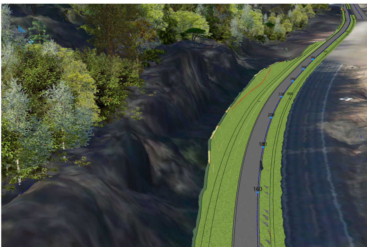
Figur 75: 3D-modell av ferdig utsprengt bergskjæring ved Åbydalen 1.
