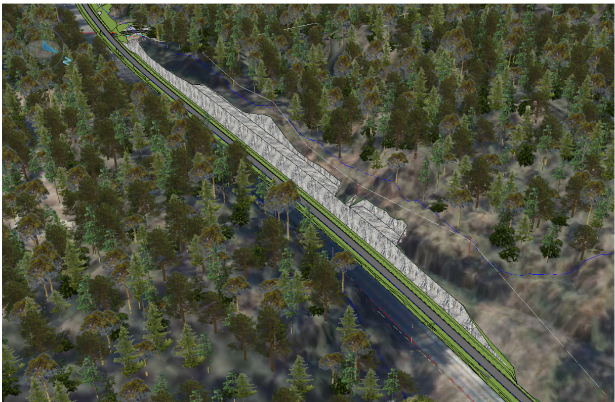
Figur 63: 3D-modell av ferdig utsprengt bergskjæring ved Esa sør 1.
