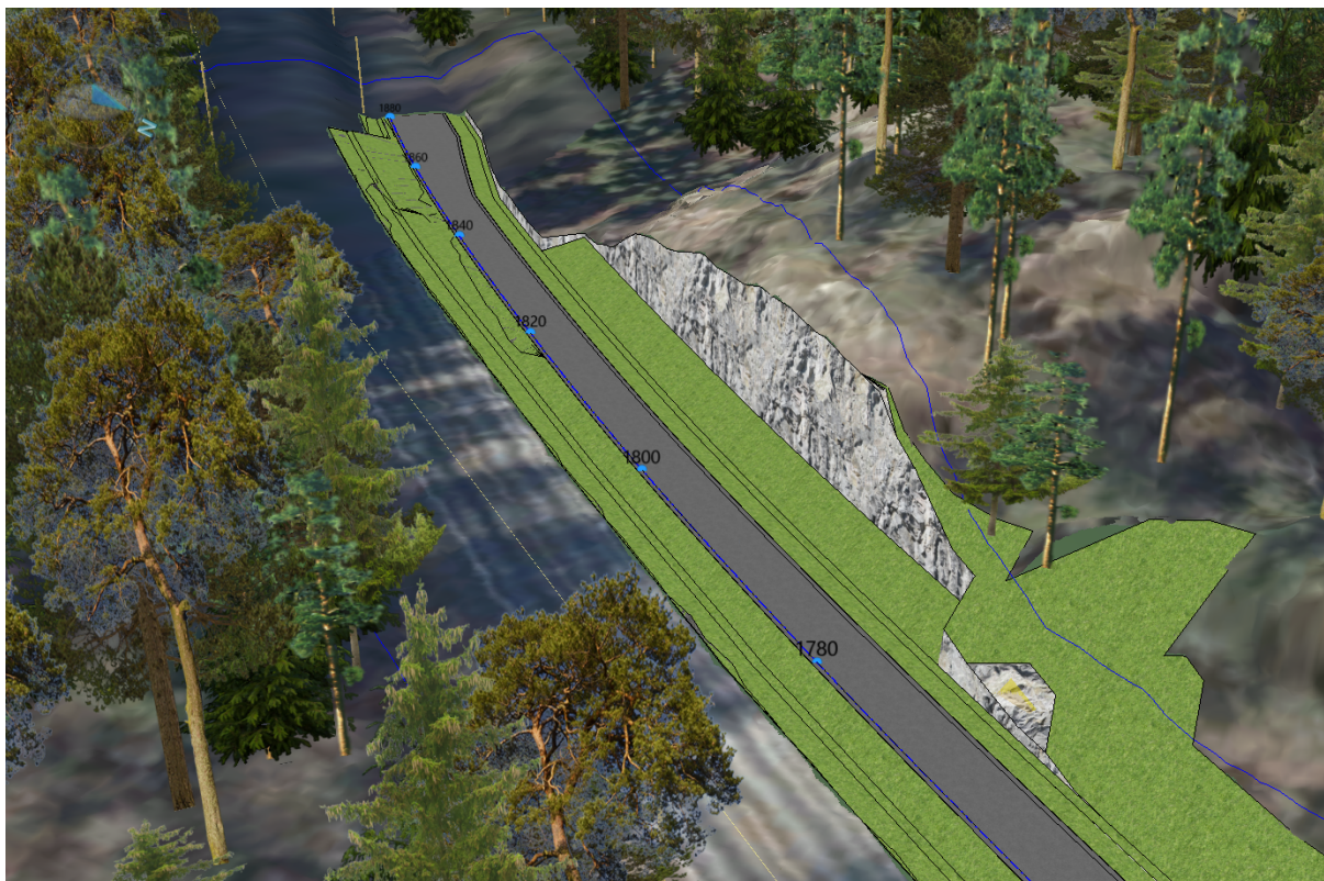
Figur 72: 3D-modell av ferdig utsprengt bergskjæring ved Esa sør 2.
