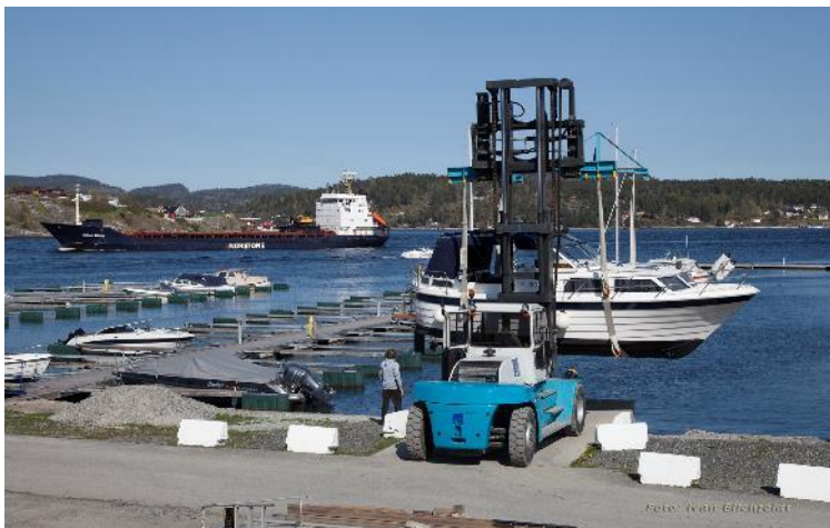
Fig. 19: Uttak av båt med truck
