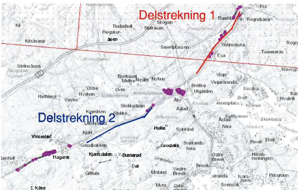
Figur 5: Utsnitt kvikkleirekart hvor delstrekninger er markert med blå og rød linje. Lilla punkter markerer kvikkleirepunkter kartlagt av Statens vegvesen.
