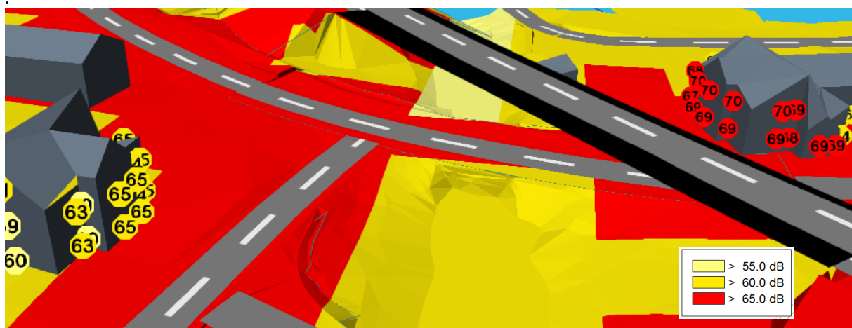
Figur 4-6: Findal bru – felles linje uten skjermingstiltak, 3D utsnitt. Støy beregnet 1,5 meter over terreng og fasadenivå av L_{den} er angitt i begge etasjene til boligene. Vist fra sør.
