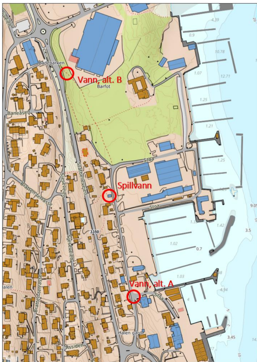
Fig. 7: Kartutsnitt med tilkoblingspunkter for spillvann og vannforsyning
