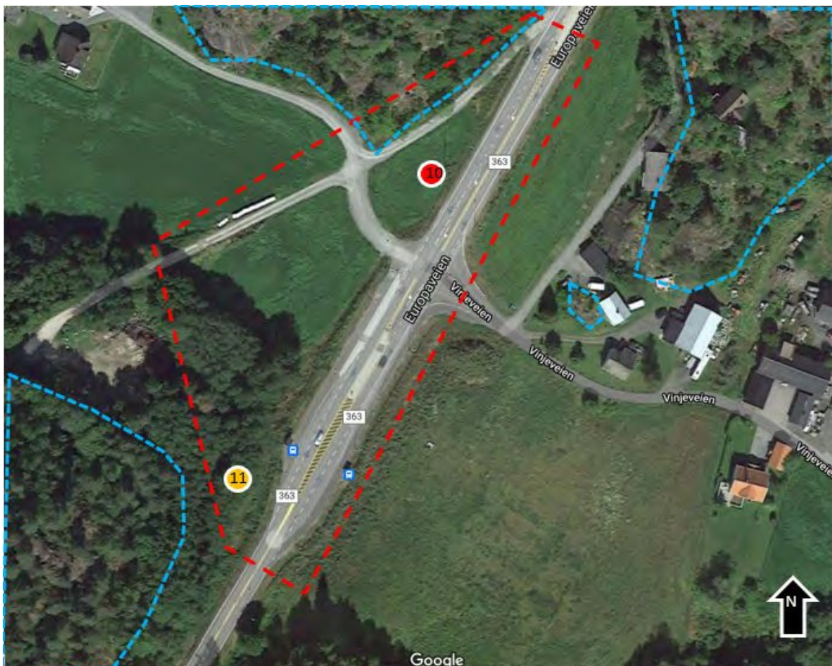
Figur 8: Flyfoto med omtrentlig utstrekning av profil 1200-1450 (rødt) og plassering av totalsondering 10 og 11. Fjell er omtrentlig markert med blå stiplede linje.
