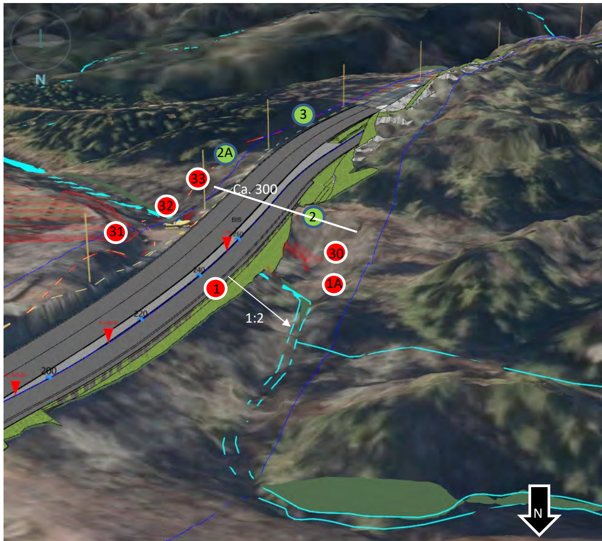
Figur 4: Skråfoto over profil 0-300 med omtrentlig plassering av totalsondering 1-3 og 30-33. Rødt indikerer forekomst av sprøbruddmateriale/kvikkleire. Grønt indikerer ikke sensitive masser.
