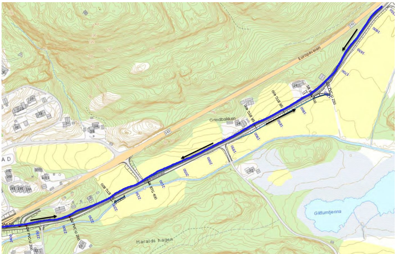
Figur 13 Hovedprinsipp for dretnsløsning fra P700 til P1550. Blå markering illustrerer åpen dretnsløsning, rød illustrerer lukket. Dretnsretning er markert med svarte piler.
