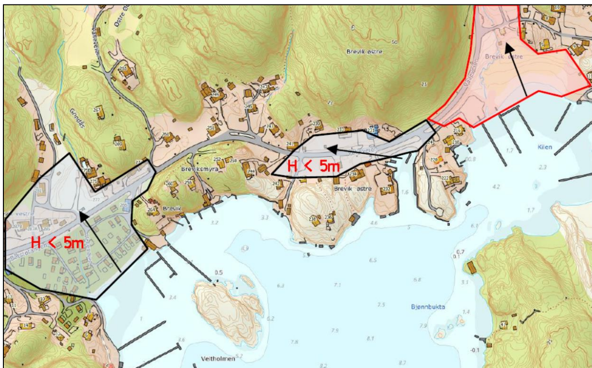
Fig. 12: Områder som kan være utsatt for områdeskred (Grunnteknikk AS)
